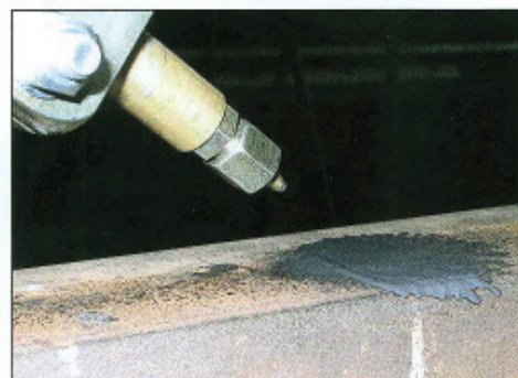
Abb. 5: Position Sprühdüse bei mobilen Kurvenschmieranlagen.
